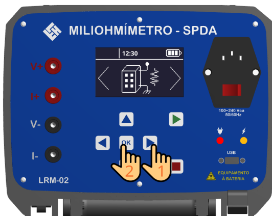
Figura 38: Indicação ilustrativa frontal do equipamento demonstrando navegação e seleção do ícone SPDA.
