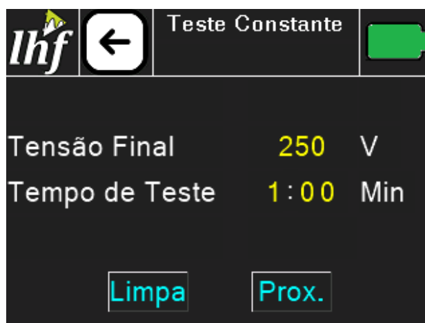
Figura 6 – Tela de configuração do teste em tensão constante.
