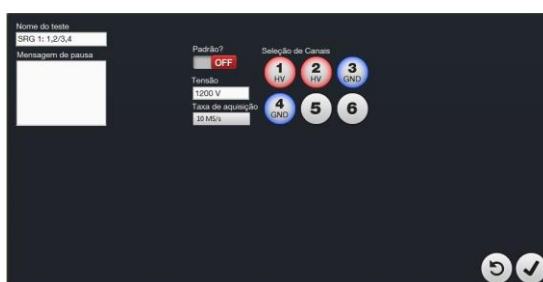
Figura 16 - Cadastro surge test sem padrão
