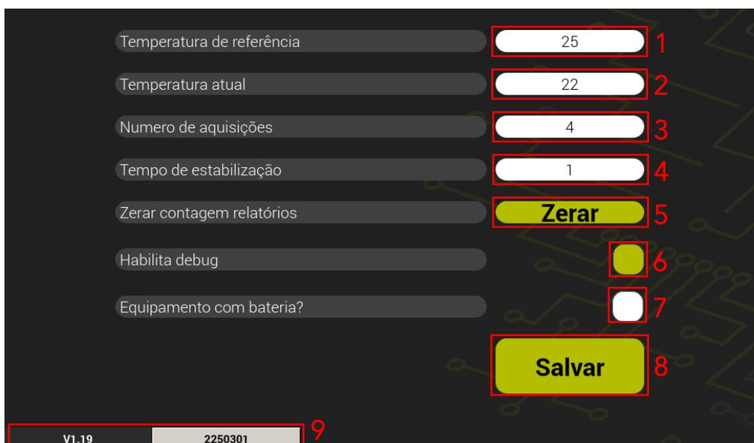
Na interface de configuração é possível alterar algumas características dos testes realizados como tempo e número de aquisição dos testes, temperatura entre outras. Abaixo é explicado os itens demarcados na Figura.
