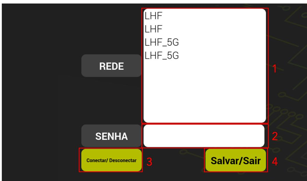
A tela de configuração Wi-Fi é destinada para conexão Wi-Fi entre o dispositivo e uma rede de internet conhecida. Abaixo é explicado os campos demarcados.
