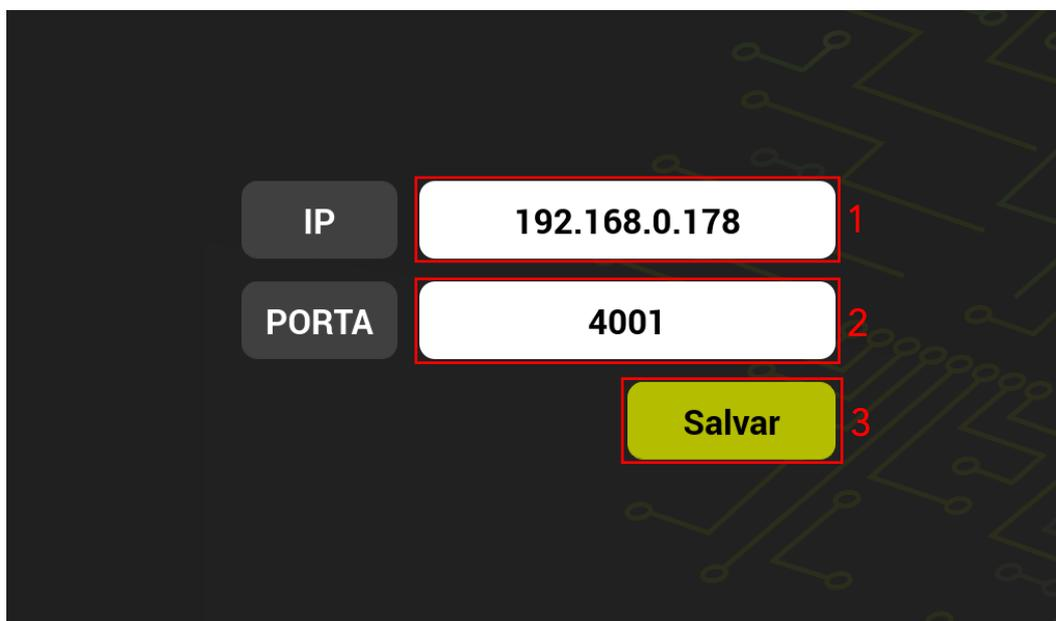
A tela de comunicação permite alterar a porta de comunicação do equipamento e visualizar o IP configurado quando acessado em alguma rede.
