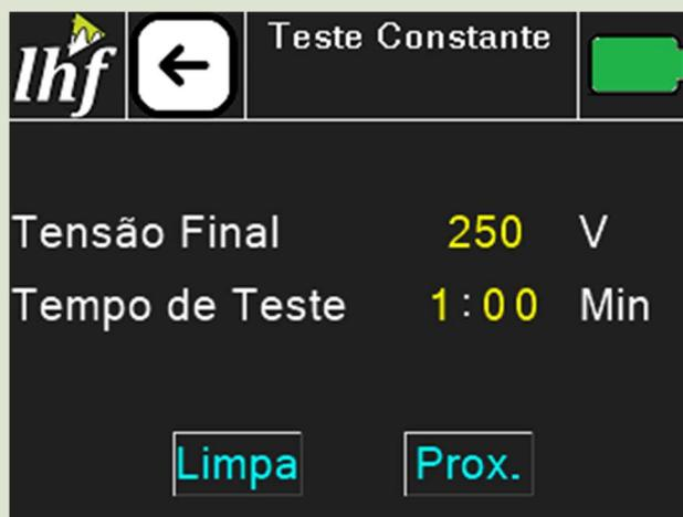
Figura 6 – Tela de configuração do teste em tensão constante.
